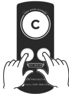
Dispensación de agua caliente
